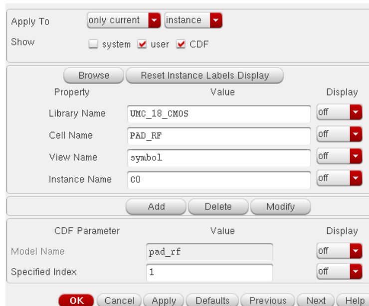
Figura 4-26. Cuadro de diálogo de Cadence de ajuste de parámetros de un PAD_RF.
