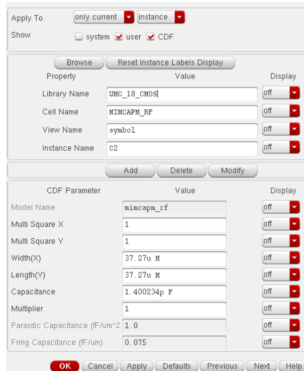
Figura 4-7. Cuadro de diálogo de Cadence de ajuste de parámetros de condensador.
