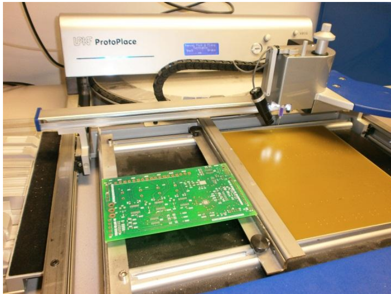
Figura 3-14. PCB y Pick&Place manual para la colocación de los componentes SMD
