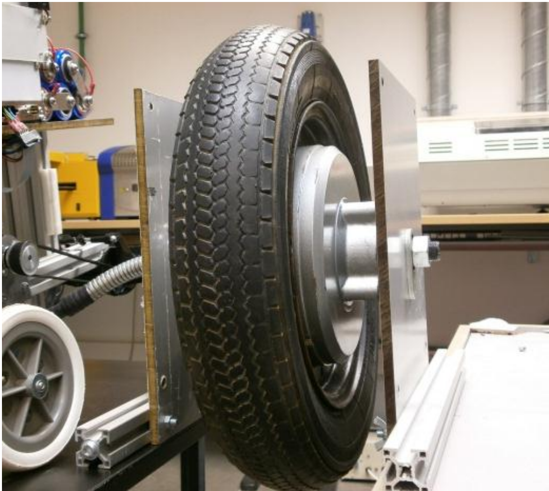
Figura 7-5: Motor BLDC de 6 fases para motos eléctricas
