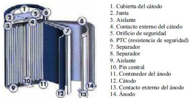
Figura 2-25: Estructura de una batería de ión-litio
