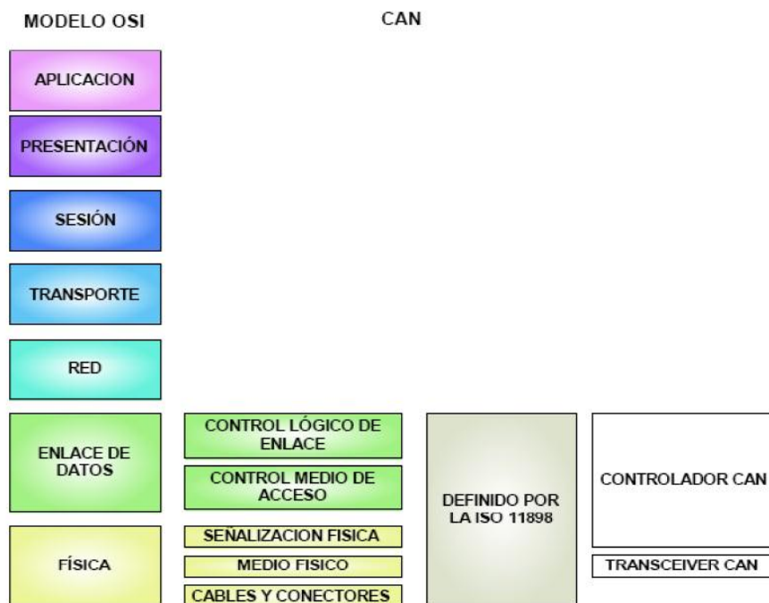
Figura 2-21: Relación entre el modelo OSI y CAN
