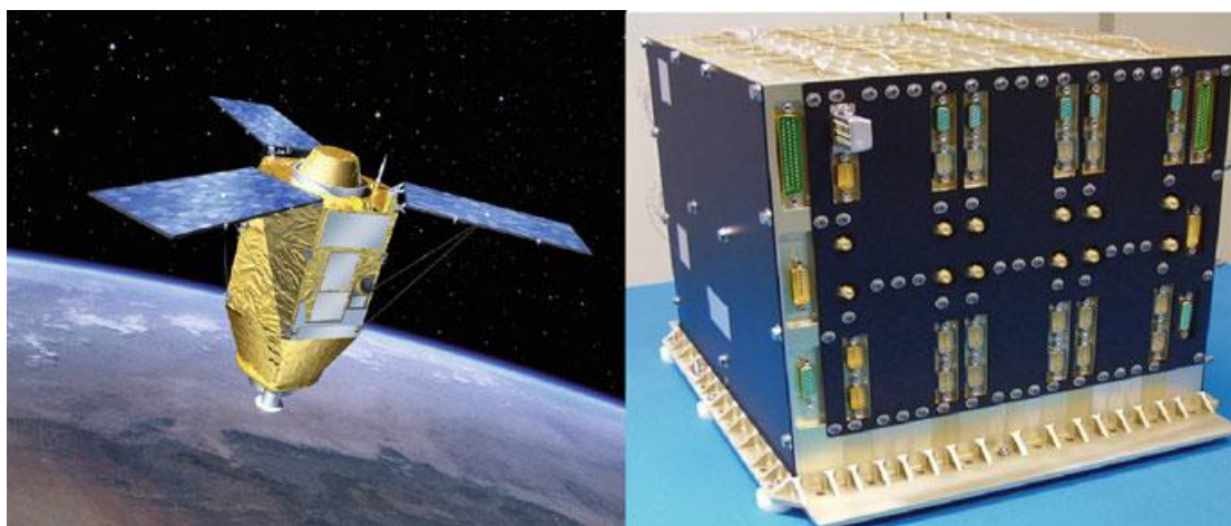
Figura 1.2. Satélite PLEIADES-HR (izquierda) y su unidad de compresión (derecha)
